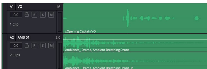
A1 — монодорожка с одной полосой, A2 — стереодорожка с двумя полосами
