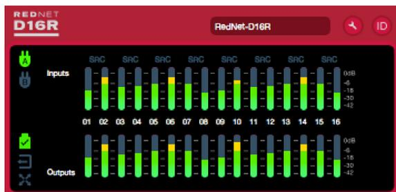
L'illustration ci-dessus montre un RedNet D16R avec tous les signaux d'entrée et de sortie présents sans SRC allumé. Le périphérique utilise la PSU A et est verrouillé sur le réseau.
