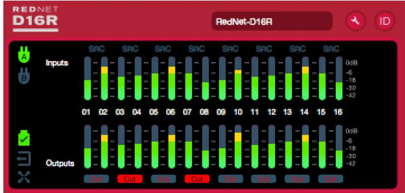
Lorsque l'option AES3 Output Cut est désactivée dans le menu Outils, l'appareil envoie toujours des informations (une série de zéros) sur ses sorties AES3, ce qui empêche les appareils situés en aval, tels que les amplificateurs, de faire la distinction entre 'mute' et 'default'. ' Etat.
