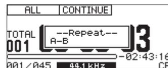
Cela termine le réglage de l'intervalle (A-B) et la lecture en boucle A-B démarre.
